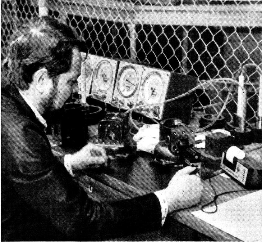
*Zu denen, die sich für beste Qualität einsetzen, gehört Genosse Siegfried Hochleiter aus dem VE B M aschinen- und Apparatebau Schkeuditz. Unser Foto zeigt ihn bei der Endprüfung hermetischer Kältemittelverdichter einer neuen Baureihe, die das Weltniveau bestimmt.*
