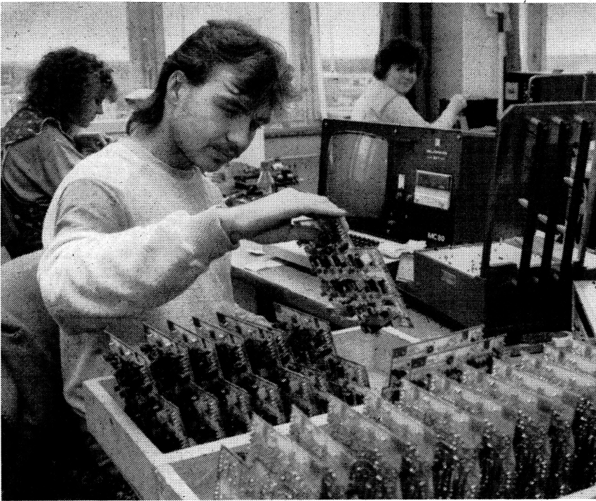
Ein zuverlässiger Partner für die Konsumgüterproduktion ist der VEB Kontakbauelemente Luckenwalde. Durch zusätzliche Lieferung von Funktionsleiterplatten helfen die Werktätigen dieses Betriebes, das Angebot an Plattenspieler zu verbessern. Im Bild: Steffen Palm aus der Brigade „Freundschaft“ bei der rechnergestützten Funktionsprüfung der Leiterplatten.
