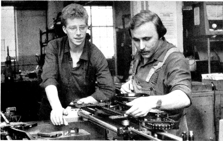
Bei der Montage eines Stapelmagazins, einer Zusatz-einrichtung für die Dreimeßer-Schneidemaschine Jugendbrigadier Torsten Hesse (rechts) und Vertrauensmann Klaus Kratzig. Nicht nur fachlich, auch bei der Festigung des Kollektivs wirken beide eng zusammen. Foto: SZ/Gröning
