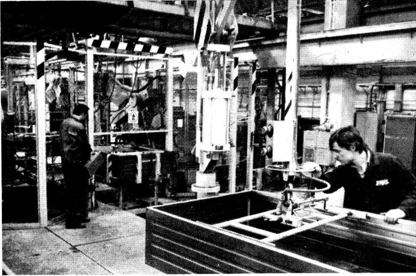
Moderne Technik im Bereich Konsumgüterproduktion des VEB Stahl- und Walzwerk Brandenburg. Junge Facharbeiter des Jugendobjektes „PKW-Anhänger HP 500“ (unser Foto) überwachen das Punktschweißen der PKW-Anhängerkästen durch Roboter.
