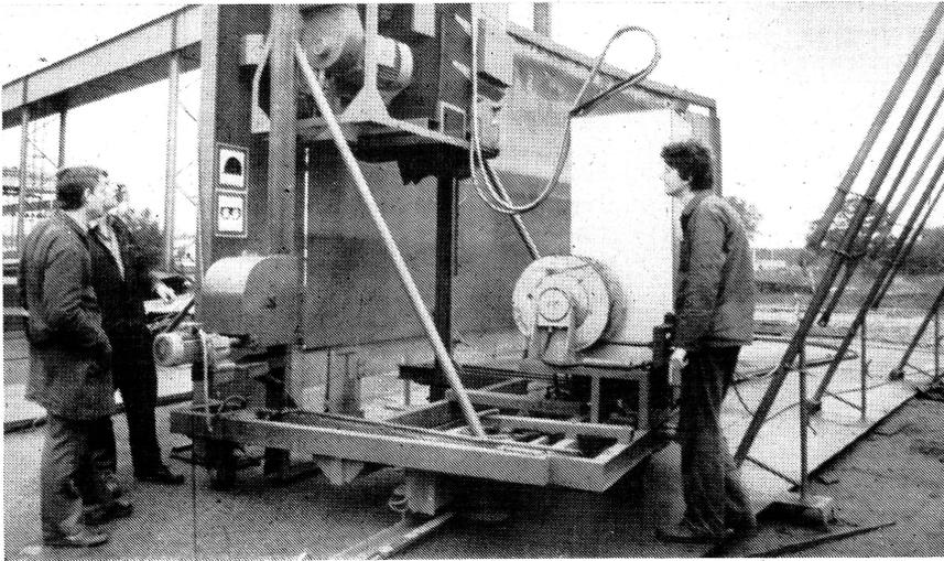
Ein Rationalisierungskollektiv des VEB Chemie- und Tankanlagenbau entwickelte und baute in nur 4 Monaten einen Roboter zum Strahlen von Tankblechen, der 7 Arbeitskräfte ersetzt. Genosse Schreiber (links), Mitglied der APO-Leitung des Bereiches Forschung und Entwicklung, mit Kollegen des Rationalisierungsmittelbaus und der Produktion beim Probetrieb.
