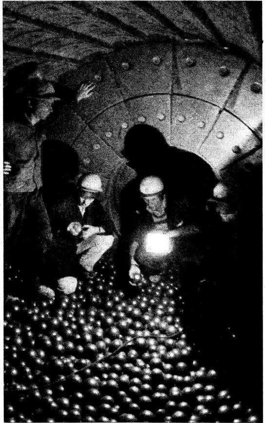
Ein Erfinderkollektiv aus dem VEB Zementwerke Bernburg, dem Institut für Zement Dessau und dem VEB Stahlgießerei Karl-Marx-Stadt entwickelte eine neue Legierung für Mahlkugeln von Zementmühlen. Diese Neuerung spart 11 000 Tonnen hochwertiger? Importstahl ein, verringert die Stillstandszeiten und erhöht dadurch wesentlich die Produktivität der Zementanlagen. Das Kollektiv wurde für diese wissenschaftlich-technische Leistung mit dem Orden „Banner der Arbeit“ Stufe I geehrt.
