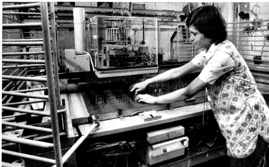
Genossin Marion Pohl gehört zu einem Jugendkollektiv des VEB Numerik Karl-Marx-Stadt, das zusammen mit Technologen dieses Werkes einen Industrieroboter zur Fertigung von Formkabeln installierte und nun auch seinen Einsatz überwacht.
