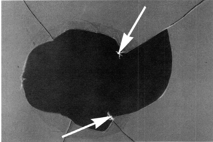
Bild F 41 Faserspuren an Fensterscheibe im UV-Licht
