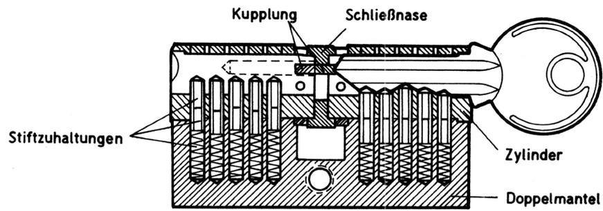
Bild 125 Zylinderschloß
