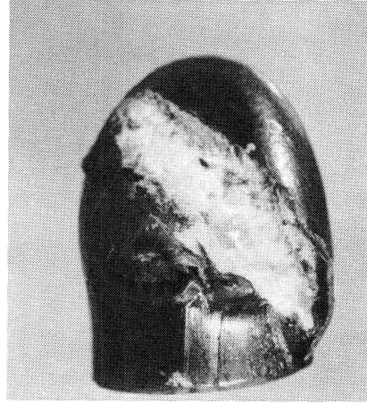
Bild 39 Spuren am Geschoß nach einem Glasdurchschuß
