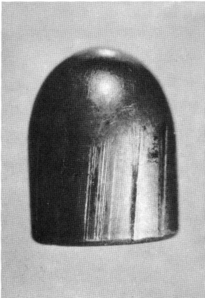
Bild 40 Spuren am Geschoß, die beim Verschießen aus einem gezogenen Lauf entstanden sind
