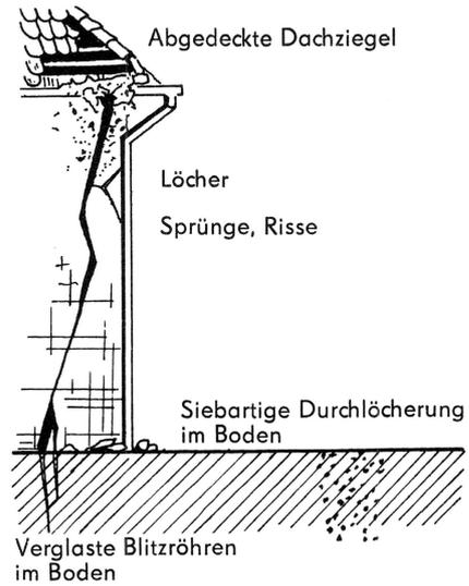
Bild 14 Spuren bei Blitzeinschlägen
