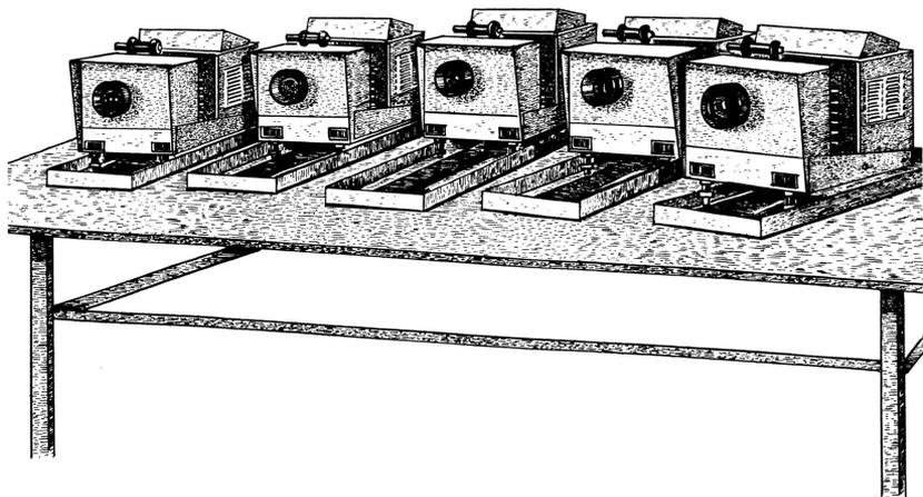
**Bild 25** In der UdSSR entwickeltes Porträtmontagegerät mit 5 Standard-Diaprojektoren, Vorderansicht.
