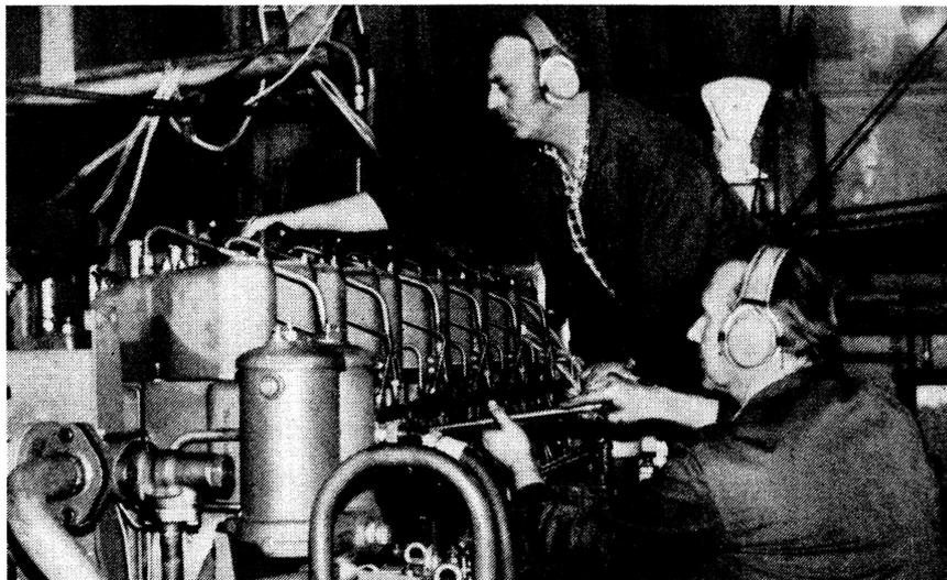
Die Genossen Erich Duldhardt und Werner Reinecke (v. l. n. r.) aus dem Stammbetrieb des VEB Schwermaschinenbaukombinat „Karl Liebknecht“ Magdeburg prüfen einen Schiffsdieselmotor auf seine technischen Parameter
