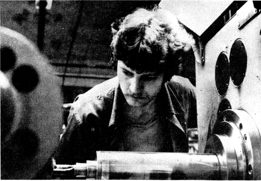
Die goldene Qualitätsmedaille des Kombines Polygraph erhielt der Zerspaner Jörg Tummescheit für seine Präzisionsarbeit. Der Zwanzigjährige ist Kandidat der SED und Mitglied der FDJ-Leitung im VEB Leipziger Druckmaschinenwerk. Hier an dem Horizontalbohrwerk bearbeitet er Plattenzylinder für eine neue Rollenoffset-Druckmaschine.
