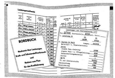
In der LPG Pflanzenproduktion Grünlichtenberg werden für alle Arbeitsmaschinen mit Motorantrieb Bordbücher aeführt. Für iede Maschine werden Leistungen und Kosten vorgegeben.
