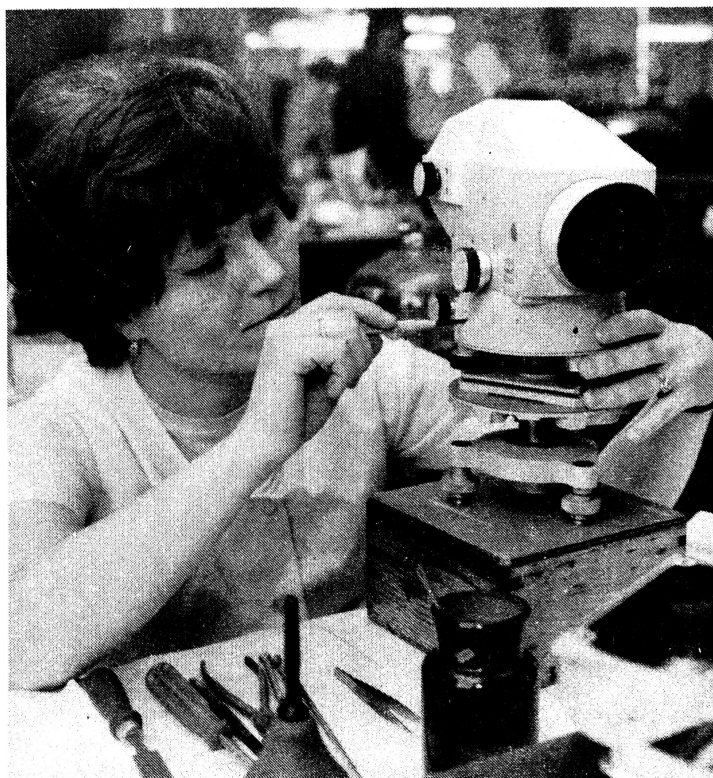
Béla Barna, Mechanikerin in den Ungarischen Optischen Werken, Budapest, bei der Montage eines Theodoliten, eines Winkelmeßinstrumentes für Geländevermessungen. Foto: Interfoto MTI/J6zsef Balaton
