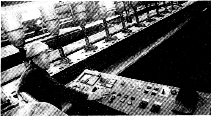
Auf den Millimeter genau werden von Helmut Erfurt aus dem VEB Chemieanlagenbau Germania, Karl-Marx-Stadt, an dieser Rollenbesäumschere Stahlbleche bis zu 20 mm Stärke zugeschnitten. Die Werktätigen des Betriebes wollen im sozialistischen Wettbewerb die Arbeitsproduktivität um 8,7 Prozent steigern und einen Produktionszuwachs von mehr als 5 Prozent erreichen. Die Zusammenarbeit mit sowjetischen Partnerbetrieben soll noch enger werden. Foto: ADN-ZB/Thieme
