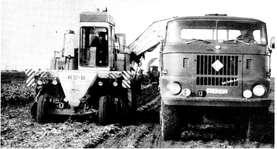
Der sechsreihige selbstfahrende Rübenrodelader KS 6 bei der Zuckerrübenerte auf den Feldern der Pflanzenproduktion Hadmersleben, Kreis Wanzleben. Mit dieser Gemeinschaftsentwicklung der Sowjetunion, der Volksrepublik Bulgarien und der DDR wird die dreifache Stundenleistung des bisher in der DDR produzierten Rodeladers erreicht. Foto: Lothar Bemick
