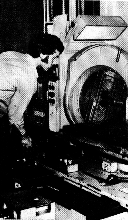
Die moderne Technik voll auszulasten und dadurch zur zusätzlichen Steigerung der Arbeitsproduktivität beizutragen, dazu verpflichteten sich die Genossen der BPO des VEB Verpackungsmaschinenbau Dresden, so auch Genosse Herzog - er bedient ein Bohrwerk vom Typ BFT 80. Werkfoto
