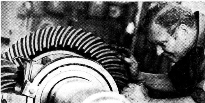
Bei der Montage eines Diesellok-Getriebes leistet Getriebeschlosser Helmut Volknant qualitätsgerechte Arbeit. Die Werktätigen des VEB Getriebewerk Gotha haben sich im Wettbewerb verpflichtet, zusätzlich rund 16 000 Arbeitsstunden einzusparen und die Selbstkosten um IV<sub>2</sub> Millionen Mark zu senken.
