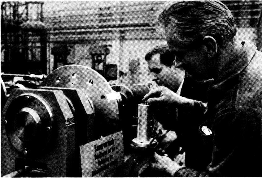
Versuchsmechaniker Werner Wehle (r.) und Ingenieur Detlev Meisel führen im Institut für Leichtbau in Dresden Verdrehversuche an Keilwellen für den Landmaschinenbau durch. Das Institut soll einen wissenschaftlich-technischen Vorlauf schaffen und Betriebe und Kombinate bei der Durchsetzung des ökonomischen Leichtbaus und des effektivsten Materialeinsatzes unterstützen.
