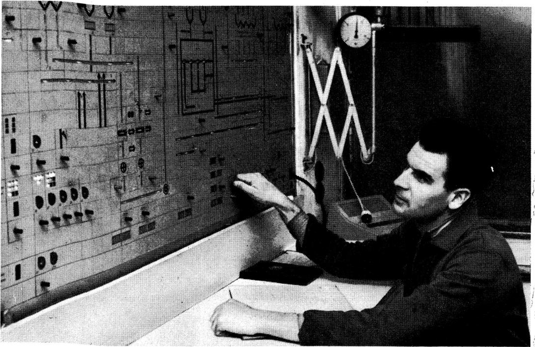
Im VIE Kombinat „Fortschritt“ Neustadt (Sachsen), Betriebsteil Bautzen, werden auf einer vollautomatischen Formanlage verschiedene Gußteile für den neuen Mährescher produziert. Von der Schaltzentrale (unser Foto) bedient Schaltwart Günter Fahle die gesamte Anlage. Foto: ZB/Löwe
