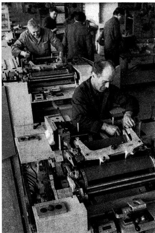
Monteur Heinz Winkler bei der Montage der hochleistungsfähigen Wollkämmaschine 1602. Dieses mit Messinggold ausgezeichnete Spitzenerzeugnis des VEB Spinnereimaschinenbau Karl-Marx-Stadt ging nach verkürzter Entwicklungszeit in die Serienproduktion.
