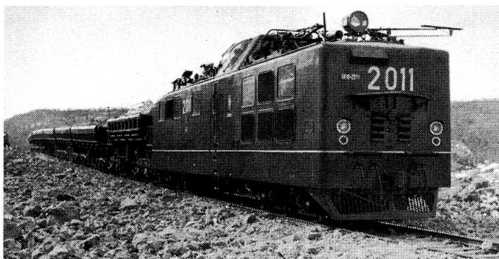
Die autonome Industrielokomotive EL 10 (kombinierte Diesel-Elektro-Lok), ein Exporterzeugnis für die Sowjetunion aus dem VEB LEW „Hans Beimler“, Hennigsdorf. Diese Lokomotive ist ein Spitzenprodukt des Betriebes und bis zu  $-50^{\circ}\text{C}$  voll funktionsfähig. Unser Bild zeigt die EL 10 in einem Bergbau Sibiriens im Einsatz.
