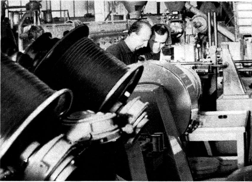
Blick in den Bereich III - Fertigung von plastisolierten Steuerleitungen auf einer hochproduktiven Verseilmaschine - im Kabelwerk Schönower, das zum Kombinat VEB Kabelwerk Oberspree gehört. Die Wettbewerbskonzeption der Schönower Kabelwerker zum 20. Jahrestag der DDR sieht für das kommende Jahr eine Erhöhung des Mechanisierungsgrades der Produktion von 62,3 auf 70 %.
