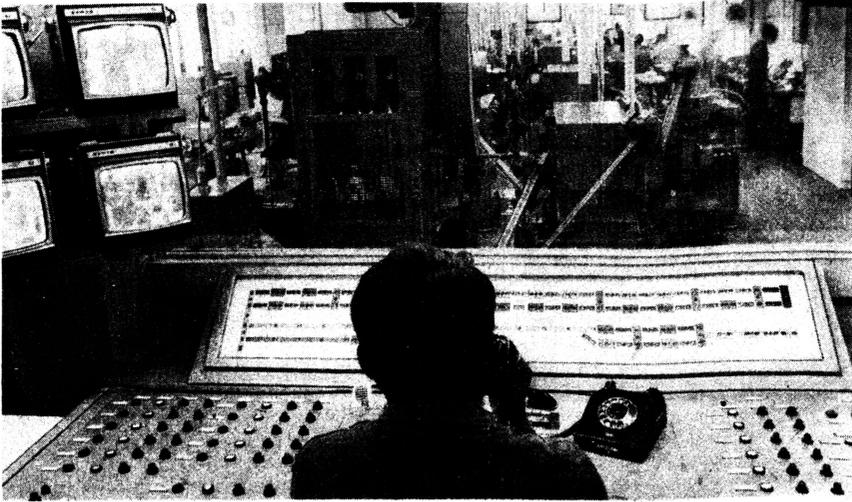
Im VEB Uhrenkombinat Ruhla wird der Produktionsablauf der automatisierten Gestellfertigung in der zentralen Schaltstation durch industrielles Fernsehen kontrolliert.
