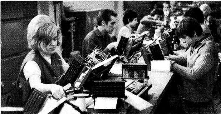
1. Der Jugendmeisterbereich WMW aus dem VEB Starkstromanlagenbau Erfurt hat seine Verpflichtungen zu Ehren des 50. Jahrestages der Großen Sozialistischen Oktoberrevolution übererfüllt. Auf dem Bild: Jugendliche verdrahten Schaltschranke für Werkzeugmaschinen.
