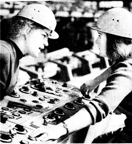
Immer mehr Frauen qualifizieren sich für moderne technische Berufe. - Ilse Beyer und Rosemarie Buchwald arbeiten an der dreifachen Rohrziehbank, auf der Rohre zu Präzisionsrohren veredelt werden.
