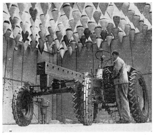
Der neue Rollenprüfstand des VEB Traktorenwerk in Schönebeck/Elbe ist nach den neuesten Erkenntnissen der Akustik eingerichtet, um die Gesundheit der Prüfmonteure zu schützen. Die Wände sind mit Glaswolle isoliert, an der Decke hängen mehrere hundert Schallabsorber.
