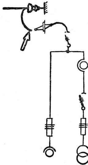
die Befestigungseinrichtung für die Abspannvorrichtung, die Durchführungen der Station und die elektrische Inneneinrichtung
