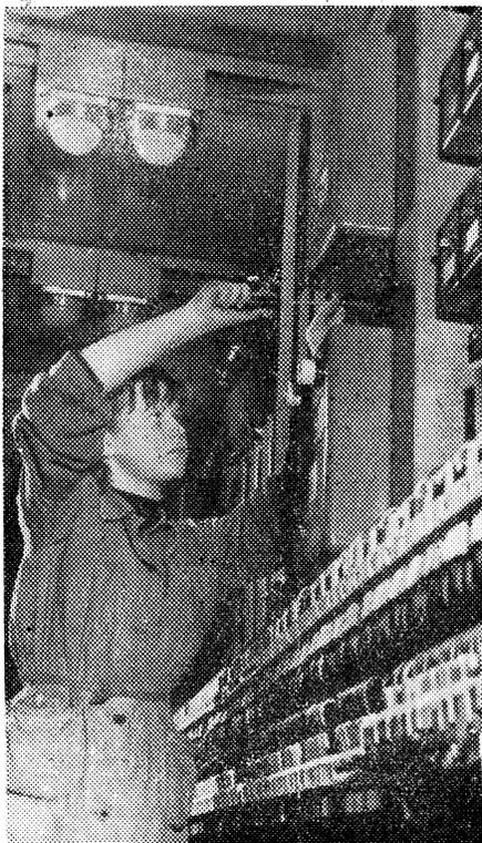
*Im VEB Geräte- und Reglerwerke, Teltow, ist ein universelles Baukastensystem für Regler- und Meßgeräte entwickelt worden und schon teilweise in die Produktion gegangen. Das System enthält die erforderlichen Bauelemente zur meßtechnischen Erfassung der verschiedenen physikalischen Größen. — Unser Bild zeigt die Kollegin Karin Seeger, Schaltmechanikerin, bei den letzten Arbeiten an einem der Überwachungsschränke für Kleinkraftwerke, die in die Volksrepublik China exportiert werden*
