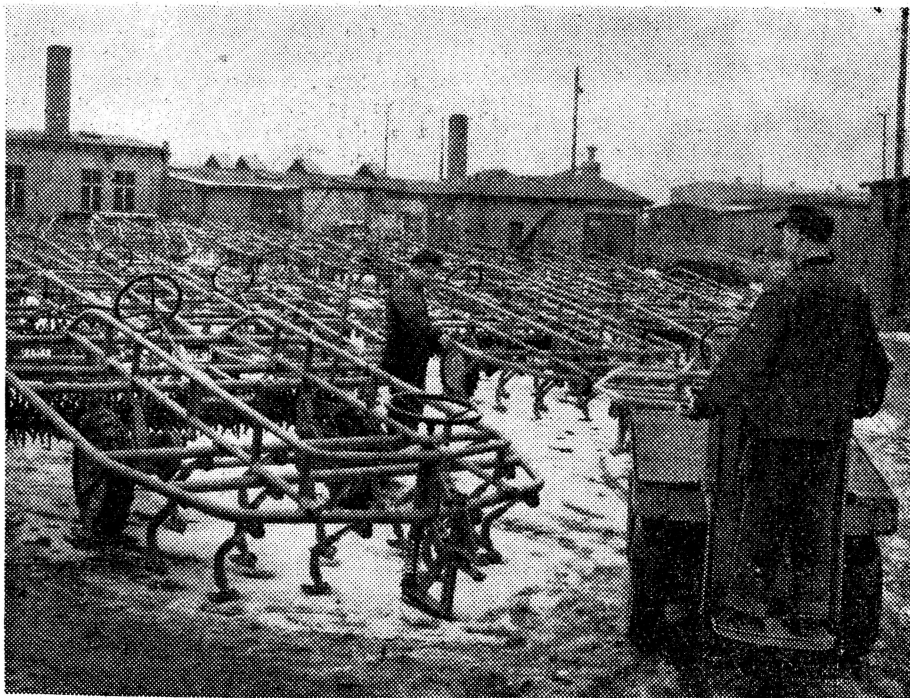
Der VEB Landmaschinenbau Torgau baute diese Kombinatoren zur Saatbettaufbereitung vom Typ K 17
