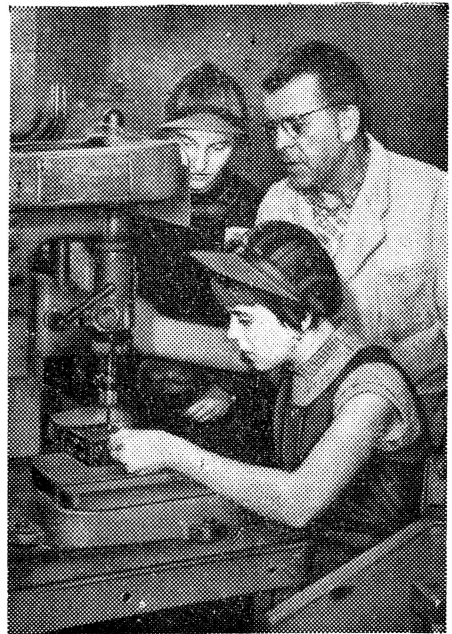
Der erste Bohrversuch am Übungsstück (Grundlehrgang Maschinenkunde)
