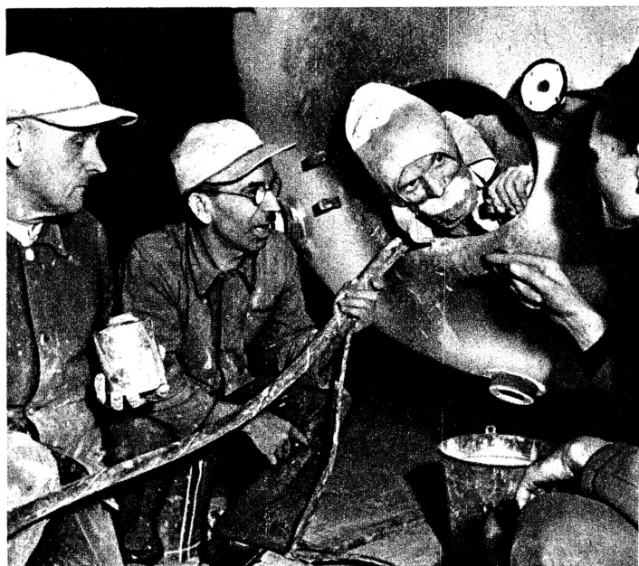
Bei der Innenemaillierung der riesigen Kessel ist ganz besondere Sorgfalt erforderlich. Der Genosse Karl Zoiker (im Kessel) verstand es mit seiner Brigade, mit nur zwei Emaillierungen die gewünschte Qualität zu erreichen. Mehrere Blasen kleinster Art erfordern jedesmal eine neue Emaillierung. (Aufn. Hensky)
