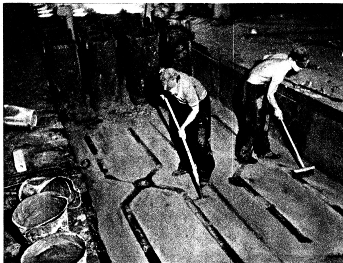
Der kleinste Schamotteeinschluß kann die Arbeit einer ganzen Schicht zu nichte machen. Schon beim Schamottieren des Gießkanals am Boden der Gießgrube (Plattenlegen) ist größte Sorgfalt am Platze, die vor dem Einsatz der Qualitätsbrigaden sehr zu wünschen übrig ließ. Im Anschluß daran wird die Gießgrube sorgfältig mit Besen und Wasserschlauch gereinigt
